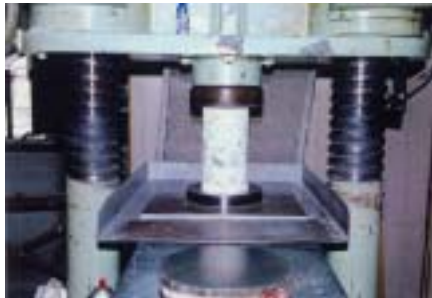
圧縮強度試験状況
