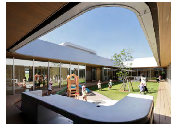
子育て交流ロビーは、自然換気システムを導入したハイサイド窓と中庭を囲む高断熱サッシから自然光が差し込む、明るく居心地の良い空間としています (上)。夏の日射を抑制する脱着式の日除けタープが設置可能な中庭には、地中の安定した温度を換気に活用するアースチューブ (地熱利用) を埋設しています (下)。
